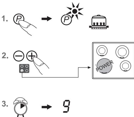
1. **Power-Taste** **P** einmal betätigen, um die Powerstufe zu aktivieren. Die Kontroll-Leuchte über der Taste blinkt.
